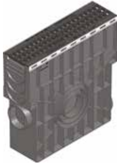
Zandvanger met kunststof-emmer, met GUGI-gietijzeren mazenrooster mazenbreedte 15/25, klasse C 250, zwart, vergrendeld
