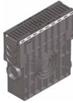
Zandvanger met kunststof-emmer, met gietijzeren sleuvenrooster, sleufbreedte 80/14, zwart, klasse C 250, vergrendeld
