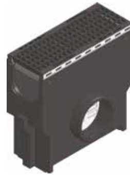
Zandvanger met GUGI-gietijzeren mazenrooster, mazenbreedte 15/25, zwart, klasse C 250, vergrendeld
