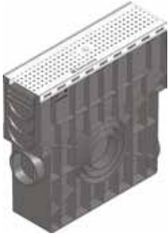
Zandvanger met kunststof-emmer, met geperforeerd klemrooster Ø 6 mm, klasse A 15, vergrendeld
