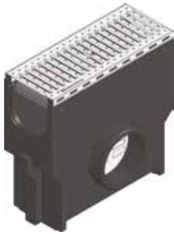
Zandvanger met verzinkt stalen emmer met klem-sleuvenrooster, sleufbreedte 130/8, klasse A 15, vergrendeld
