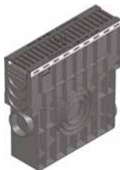
Avaloir avec panier PVC et grille fonte à fentes 80/14, noire, classe C 250, montée et clavetée
