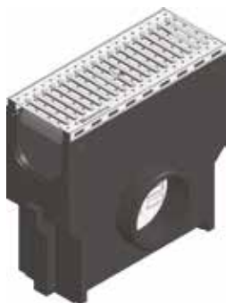
Avaloir avec panier galva et grille passerelle 130/8, galva, classe A 15, montée et clavetée
