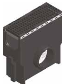
Avaloir avec panier galva et GUGI caillebotis fonte mailles 15/25, noir, classe C 250, monté et claveté
