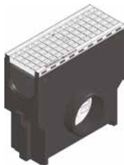
Avaloir avec panier galva et grille caillebotis mailles 30/30, galva, classe B 125, montée et clavetée
